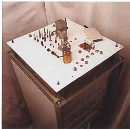
Bild 1: Teflonplatte zur Aufnahme der Sensoren.
