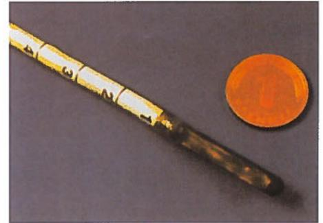
Bild 2: Linear-Schallwandler (10 MHz) mit 120 Einzelementen, flexibler Kabelzuführung mit Skala und einem max. Außendurchmesser von 4 mm.
